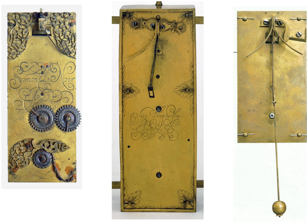
Fig. 5: Vues de dos des mécanismes de Le Noir, Treffler et Coster (D1)
