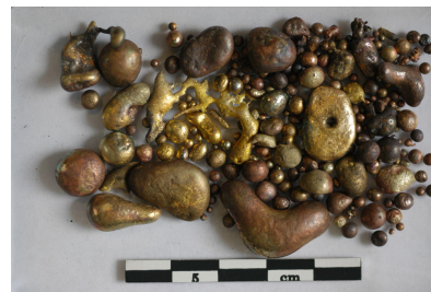
Masses métalliques obtenues après cémentation
